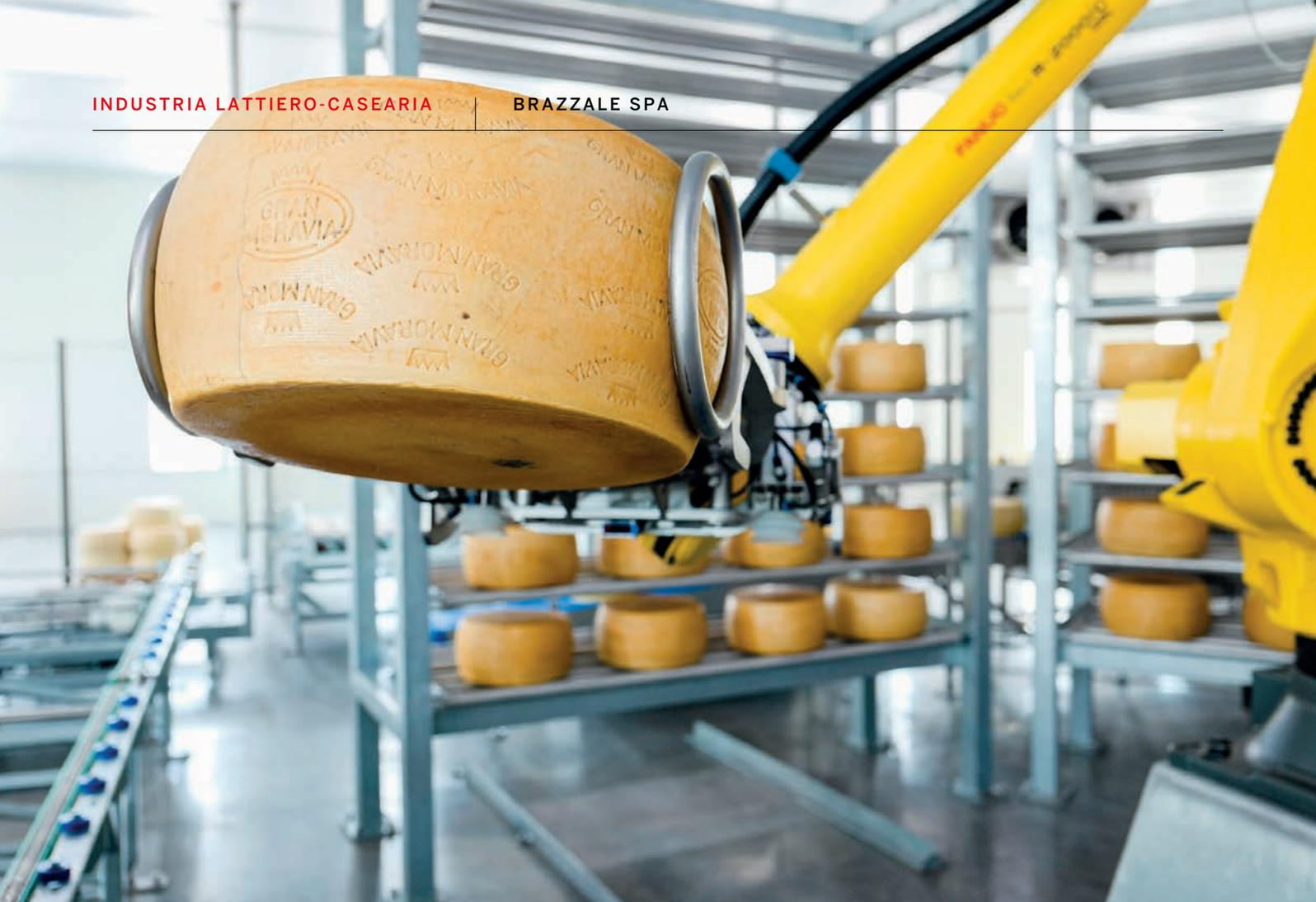
stagionatura. Contrariamente alla norma, è il formaggio a essere trasportato alle macchine per le operazioni di spazzolatura e rivoltatura, rendendo il processo altamente efficiente. Questo non solo riduce il volume del 50%, ma elimina anche gli spazi vuoti all'interno del magazzino, ottimizzando le condizioni di temperatura e umidità necessarie per una perfetta stagionatura.
