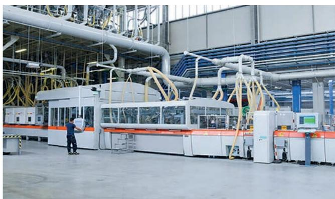
e preparazione degli impasti. Cinque impianti sono equipaggiati con linee di rettifica e lappatura per perfezionare ogni dettaglio delle superfici ceramiche.
